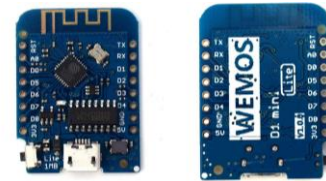
Fig. 2. WeMos D1 mini Lite Development Board.
