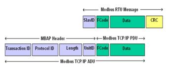
Fig. 2. MODBUS Frame Format.
