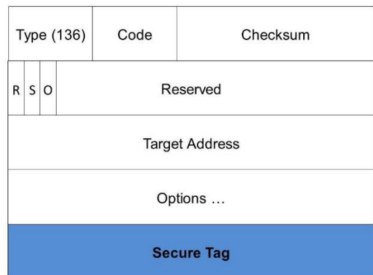
Fig. 4. Secured NA message format
